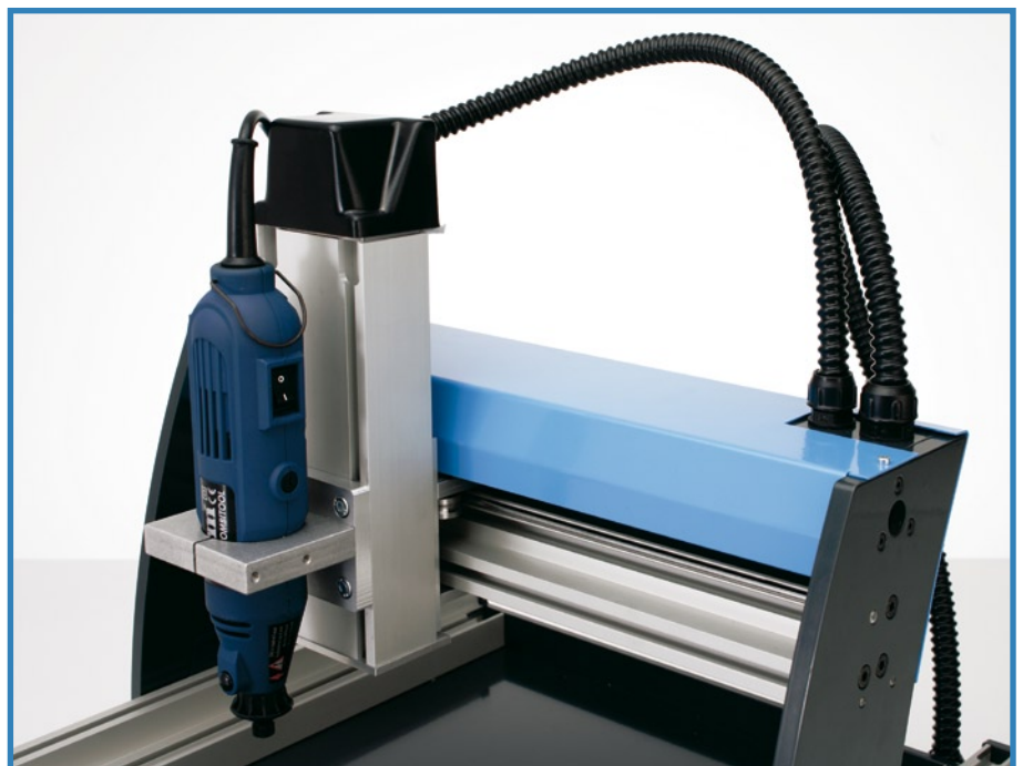
Figure 5. La colonne de perçage avec le guidage dans le portique.
